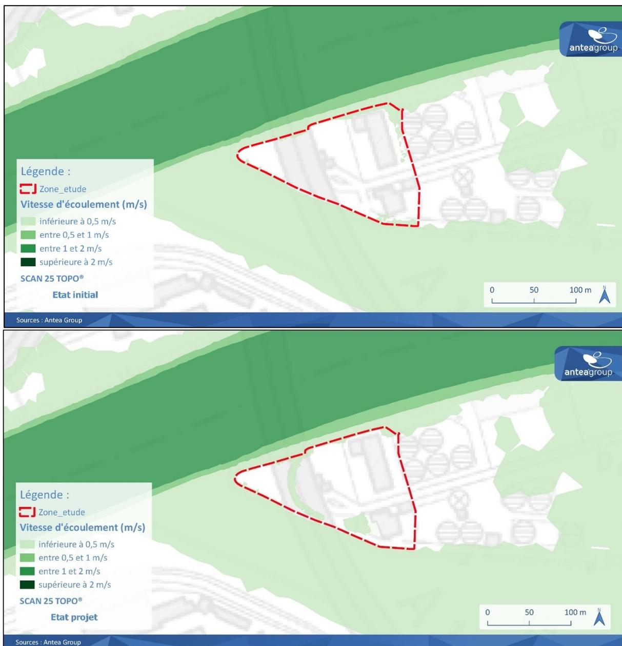
Figure 23 : Comparaison des vitesses d'écoulement entre l'état actuel et l'état projet sur le futur site de Paprec (Source : Antea Group)
