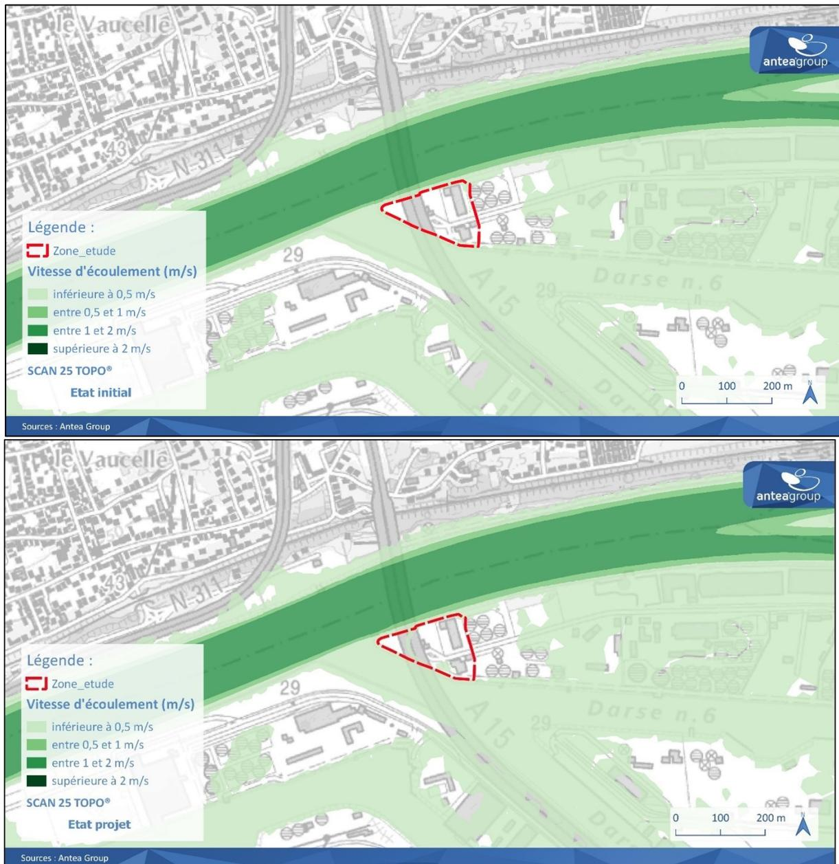
Figure 22 : Comparaison des vitesses d'écoulement entre l'état actuel et l'état projet (Source : Antea Group)
