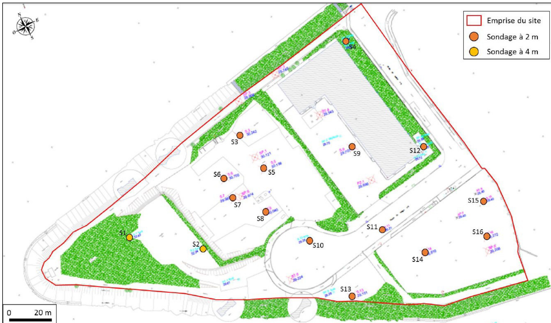
Figure 21 : Cartographie des sondages réalisés en 2020
