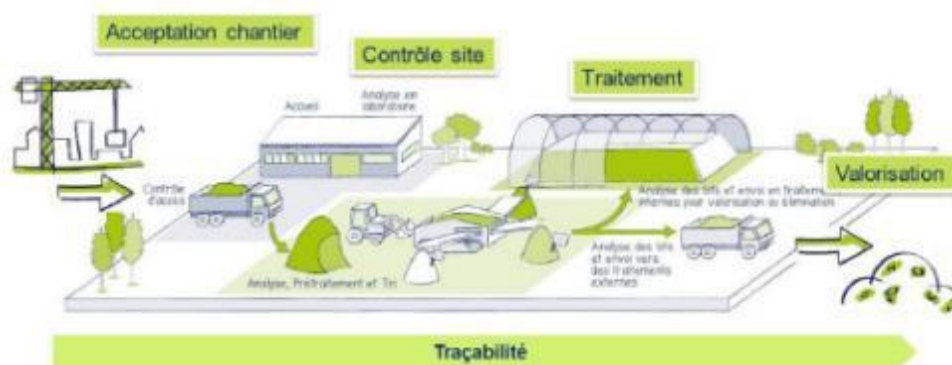
Figure 139. Synoptique de l'activité de la plateforme de tri-transit, de traitement-valorisation de terres et matériaux et de transit-regroupement de déchets amiantés conditionnés à Gennevilliers (Source : Avis de la MRAe du 12 avril 2018)
