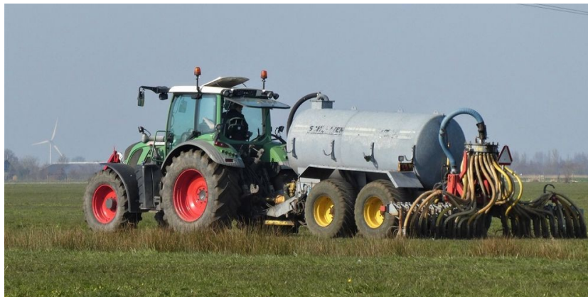
Figure 9 : Rampe à pendillards
