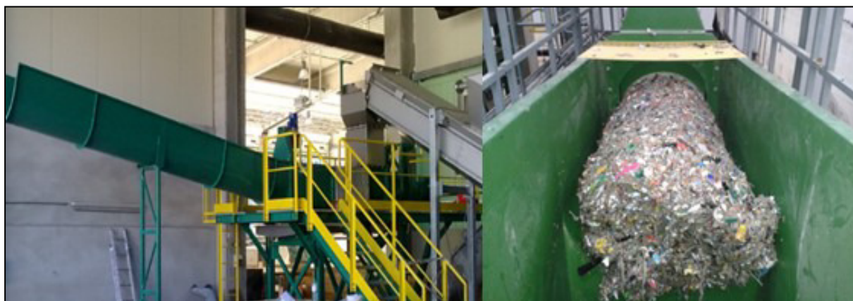
Figure 34 : Presse à vis de déshydratation des matières légères
