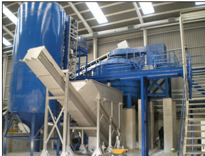
Figure 33 : Exemple de pulpeur de déchets BTA®
