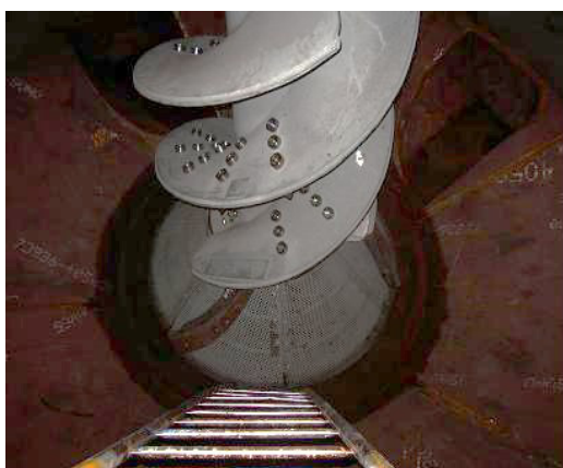
Figure 38 : Agitateur et plaque de tamisage du pulpeur
