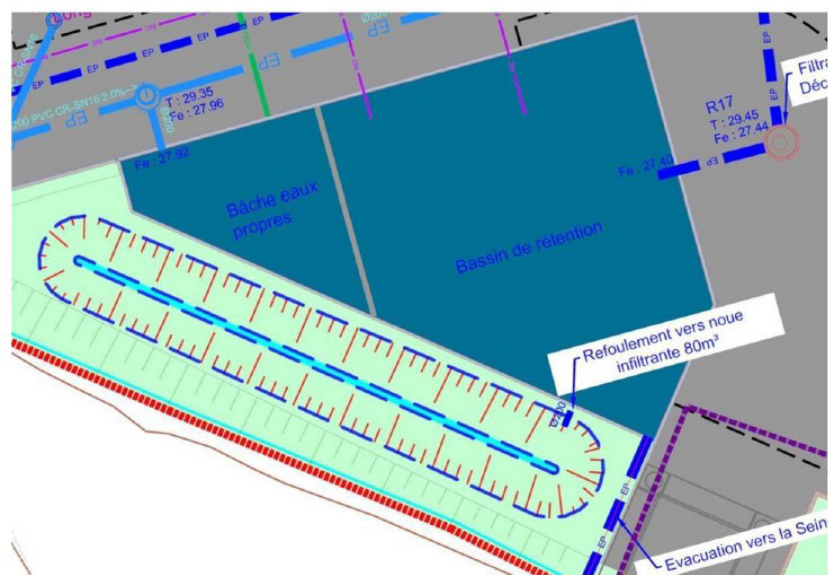
Figure 83 : noue infiltrante pour la gestion des petites pluies
