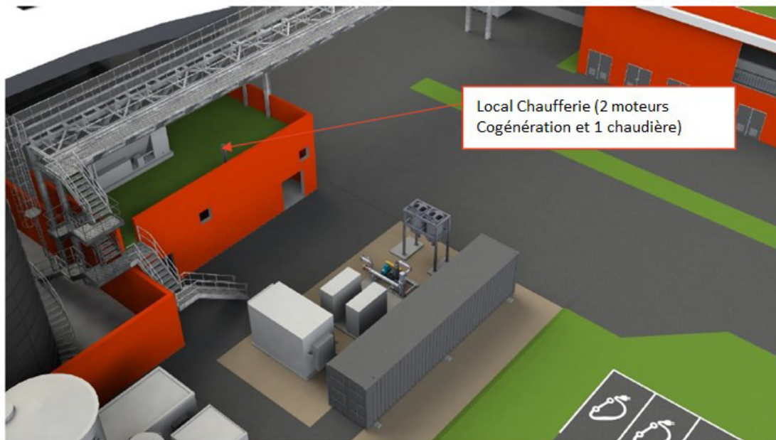
Figure 69. Implantation du local chaufferie / cogénération
