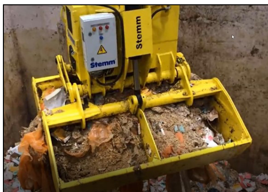
Figure 30 : Godet en cours de chargement dans la fosse
