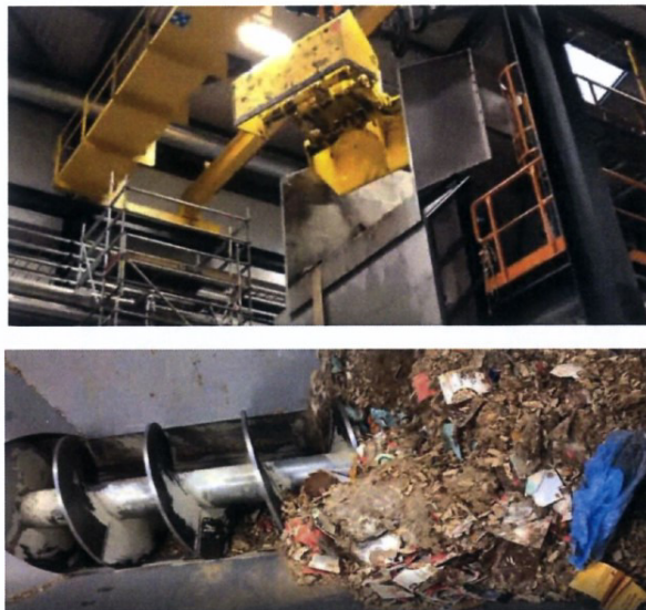
Figure 56 : illustrations trémie de chargement et vis de fond de trémie
