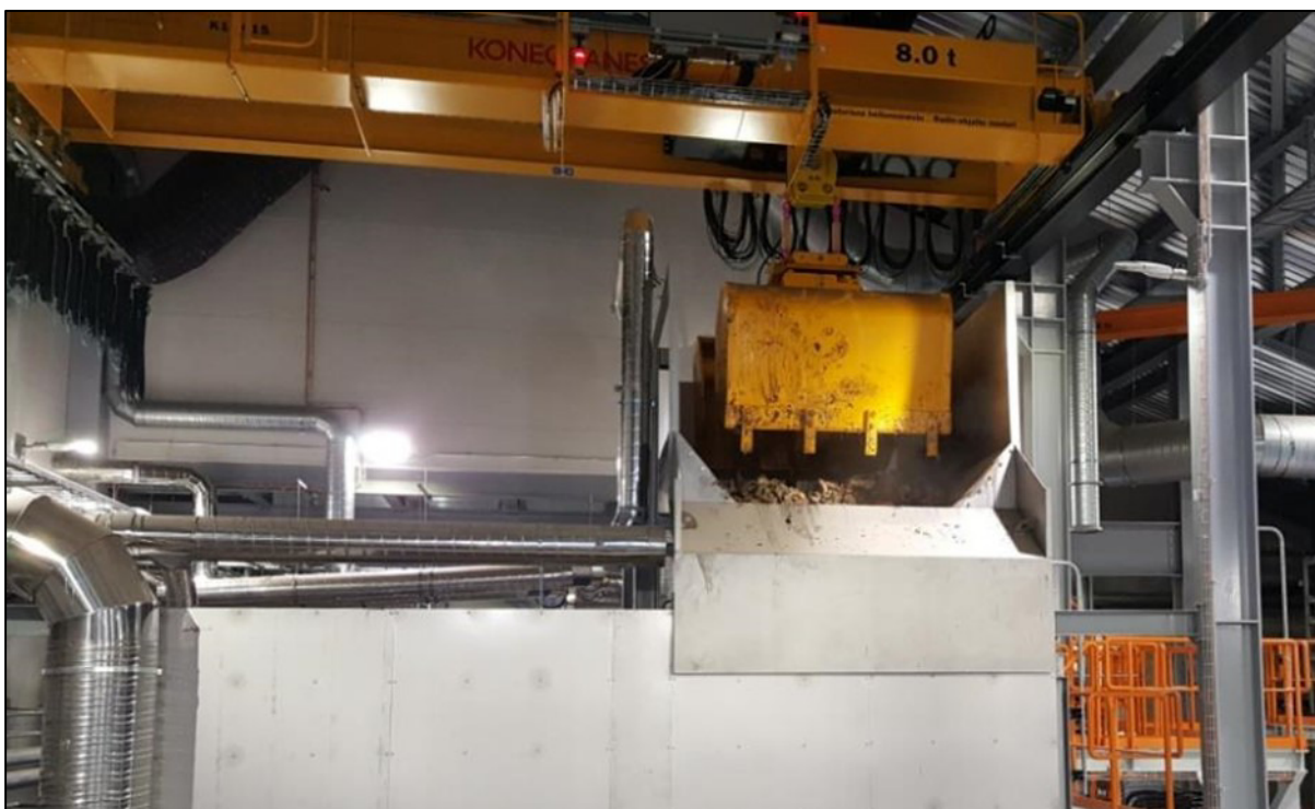
Figure 28 : Vue godet en cours de chargement trémie
