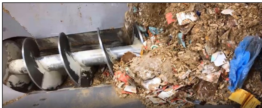
Figure 31 : Vis de la trémie de chargement en cours d'alimentation pulpeur
